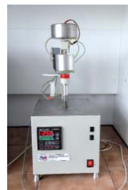
Obr. 1 Přístroje pro hodnocení materiálů vystavených sálavému teplu (vlevo) a pro stanovení prostupu tepla při vystavení účinku plamene (uprostřed) a pro stanovení prostupu tepla ochranným oděvem nebo jeho materiály při dotyku (vpravo)
