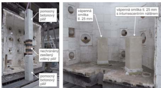
Obr. 3 Pohled do sloupové pece: a) zkušební sestava zatěžovaného pilíře 1; b) pilíře 2 a 3 ve zkušební peci
