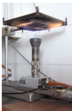
Obr. 1 Přístroje pro hodnocení materiálů vystavených sálavému teplu (vlevo) a pro stanovení prostupu tepla při vystavení účinku plamene (uprostřed) a pro stanovení prostupu tepla ochranným oděvem nebo jeho materiály při dotyku (vpravo)
