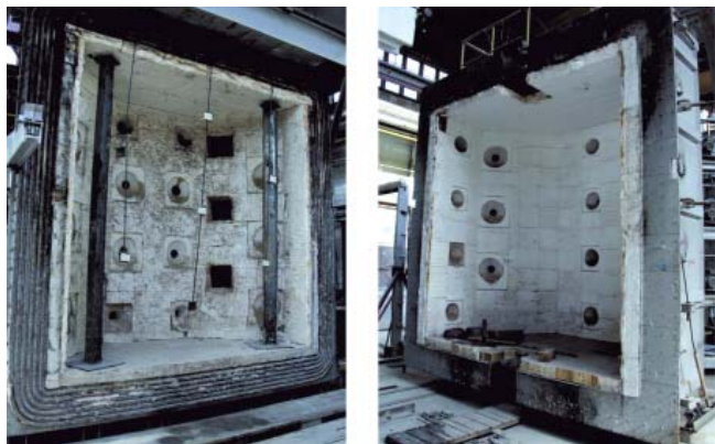
Obr. 1 Otevřená sloupová zkušební pec v požární zkušebně PAVUS, a.s. ve Veselí nad Lužnicí
